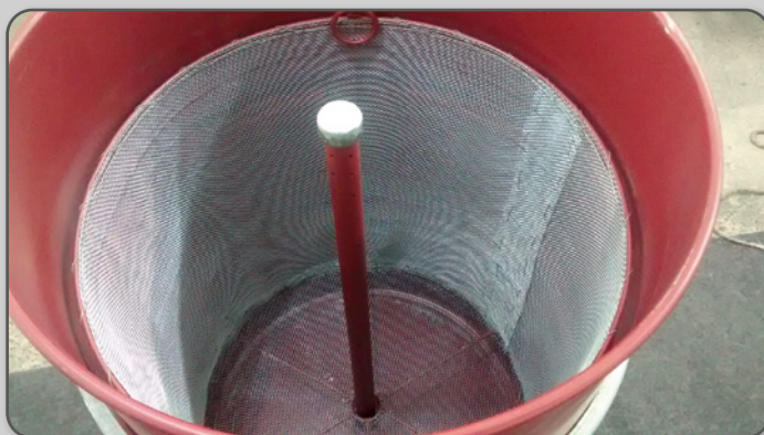
Figura 33 – Derretedor de cera a vapor
