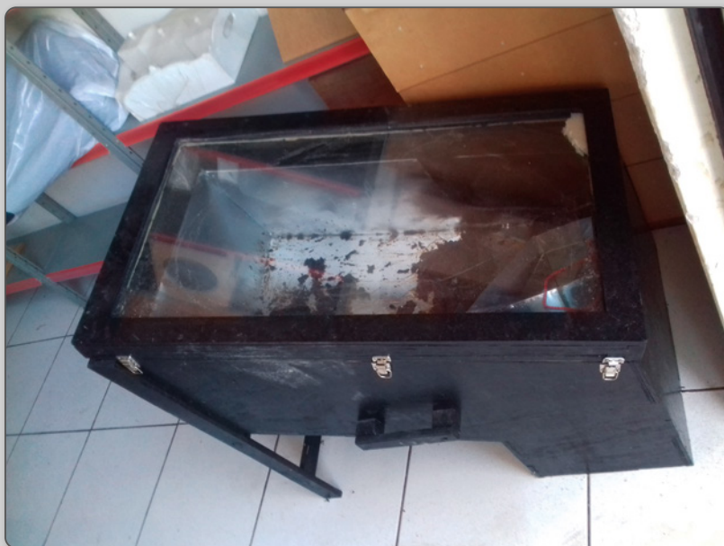
Figura 32 – Derretedor de cera solar
