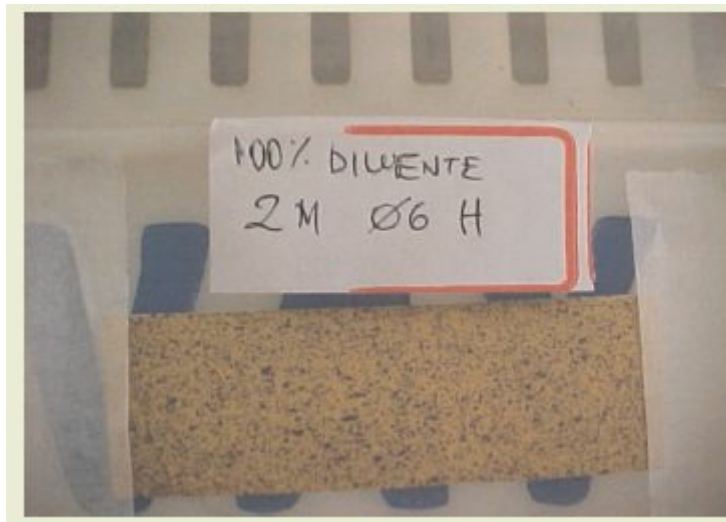
Figura 4 - Imagem de gota em soluções contendo 100% de diluente específico em pulverizador costal.
