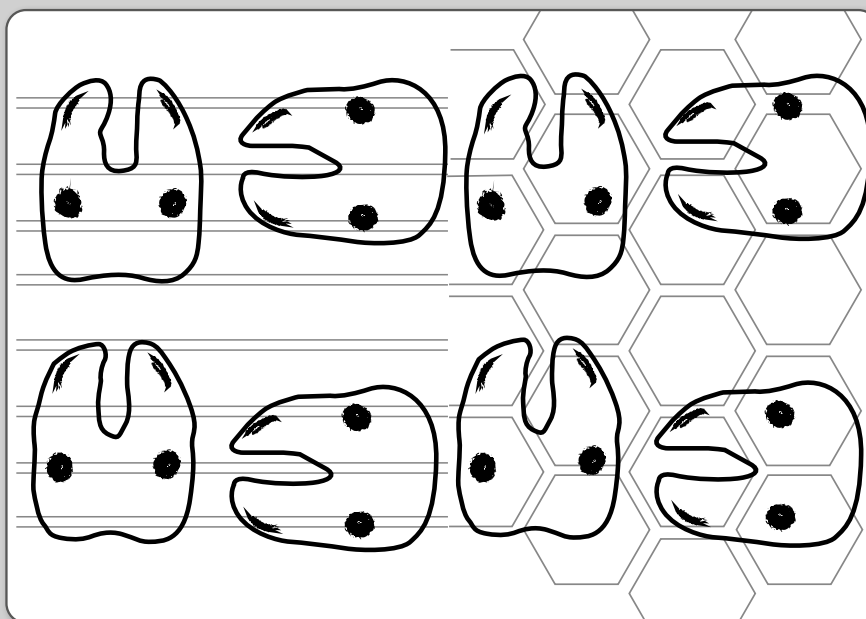
Figura 46 – Detalhe da pisadura de vacas leiteiras em pisos com frisos paralelos ou em formato de colmeia (mais antiderrapante).
