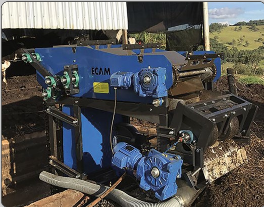
Figura 64 – Separador de sólidos dotado de elevador de canecas.
