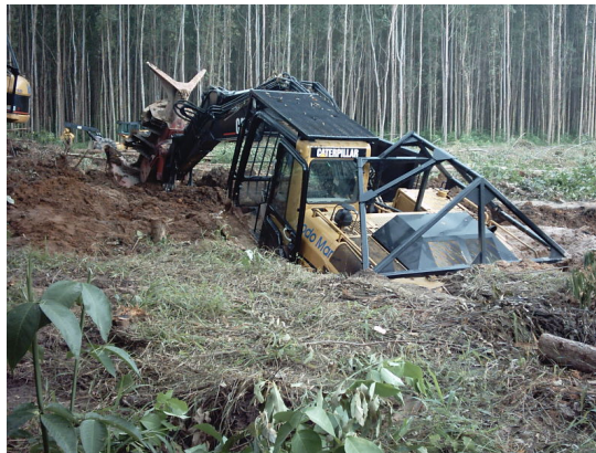
Figura 3. Trator atolado em virtude da baixa capacidade de sustentação do solo.
