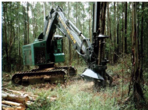
Figura 15. Cabeçote “slingshot” Risley, modelo S1821, acoplado a máquina-base Timberjack 608 (SOUZA et al., 2004).
