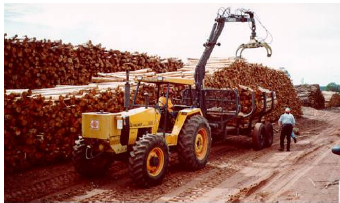
Figura 31. Trator agrícola com carreta e grua acopladas.
