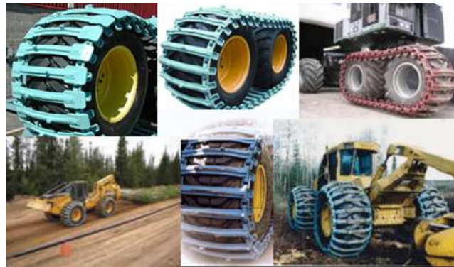
Figura 17. Diversos modelos de esteiras e sua aplicação em máquinas florestais.
