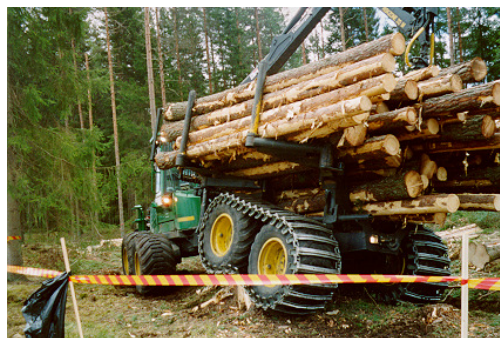
Figura 10. Eixos traseiros do forwarder Timberjack 1410D em “bogie” equipados com esteiras.
