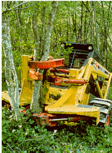
Figura 8. Cabeçote de corte incorporado ao chassi do trator.
