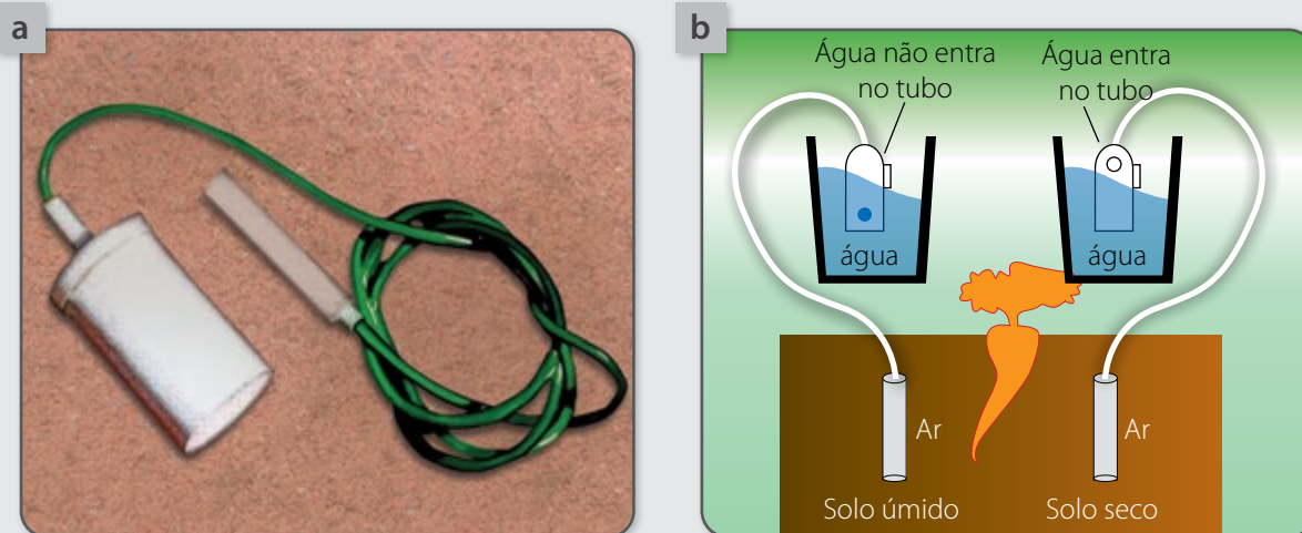
Figura 16 – Sensor Irrigas® desenvolvido pela Embrapa para manejo da água de irrigação (a), com detalhes de instalação e leitura (b).
