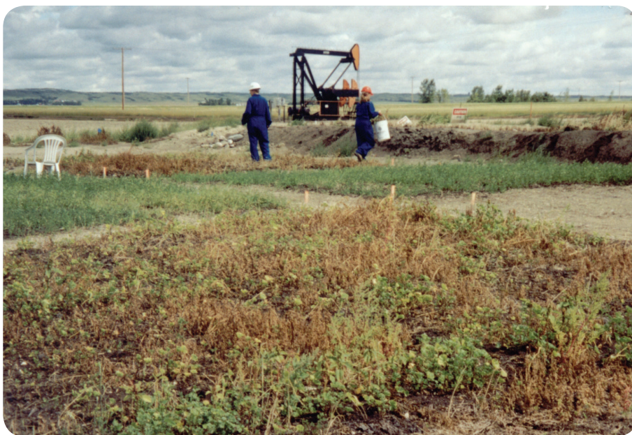
Figura 13.7. Experimento de biorremediação de solo contaminado com petróleo em Saskatchewan, Canadá. FONTE: Foto de Alexandre Verzani Nogueira – (arquivo pessoal - Alasca, EUA, junho de 2001).
